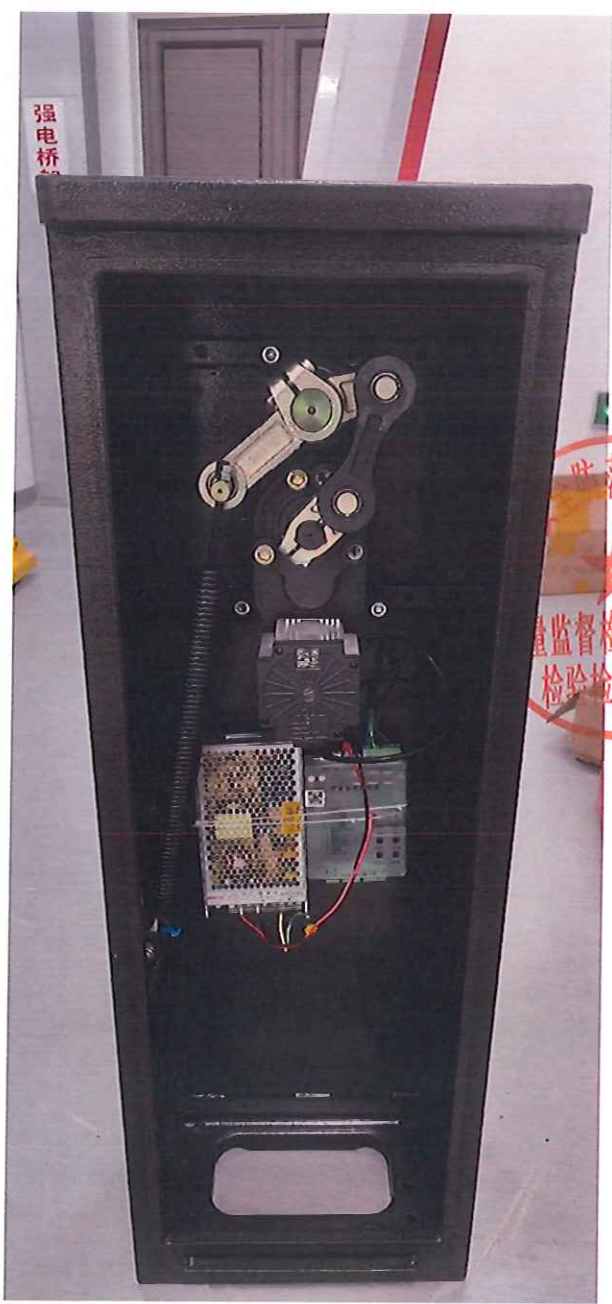
图 4 AK158-47-116-S580 型电动栏杆机机箱内部布局
